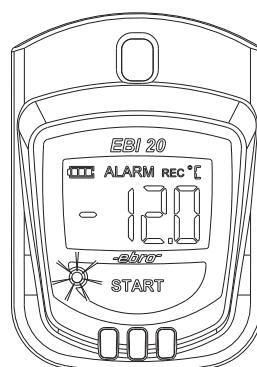
Ist eine Alarmverzögerung programmiert worden, dann wird der Alarm erst ausgelöst, wenn sich der Messwert länger als die angegebene Verzögerungszeit (ein Vielfaches des Aufzeichnungsintervalls) außerhalb des Soll-Bereichs befindet. Der Alarm wird so lange signalisiert, bis er vom PC aus über das Programmier- und Leseprogramm gelöscht wird.
