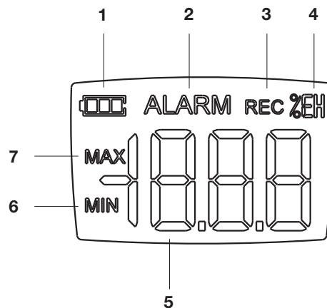
Falls Messwerte aufgezeichnet werden, signalisiert das Gerät die laufende Aufzeichnung durch die Zeichenfolge „REC“ rechts oben im Anzeigefeld (3).
